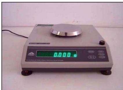
Figura 2.3. Balança semi-analítica.
