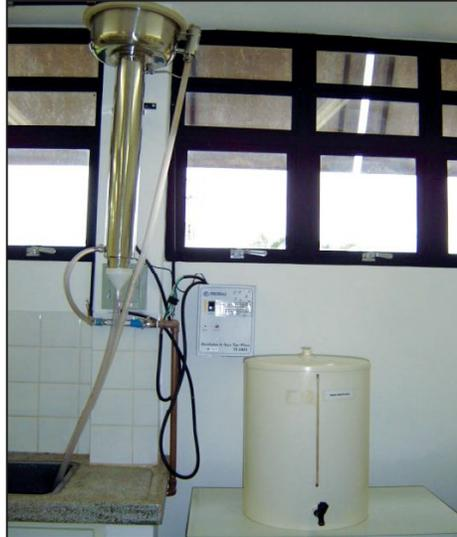
**Figura 2.7.** Destilador e recipiente para armazenar água.
