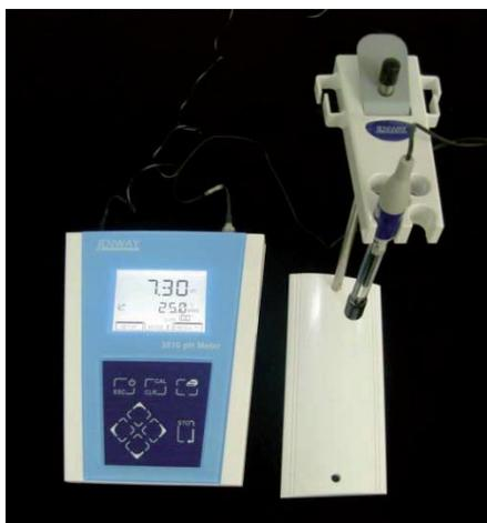
Figura 2.2. Peagâmetro: medidor de pH.
